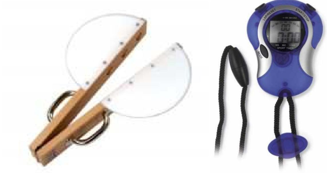
Mit der Starterklappe (Beispielbild oben links) haben wir einen Knall erzeugt. Das Zusammenschlagen findet gleichzeitig mit dem Entstehen des Knalls statt. Die Zeit zwischen dem Sehen und dem Hören wurde von euch mittels einer Stoppuhr (Beispielbild oben rechts) gemessen. Euer Abstand von der Schallquelle betrug etwa 100 Meter.
