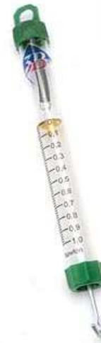
Durch die Erdanziehung wird ein Massstück zum Boden hin beschleunigt und zieht an der Feder, bis diese genug „Gegenkraft“ (das kommt nach den Ferien) aufgebaut hat und die Masse „festhält“. Mit dieser Methode können wir nun auch Massen vergleichen und wiegen.
