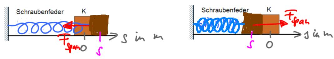
In Variante 1 zieht die überdehnte Feder gegen die positive  $s$ -Achse, also ist  $F_{span} = -D \cdot s$ .
