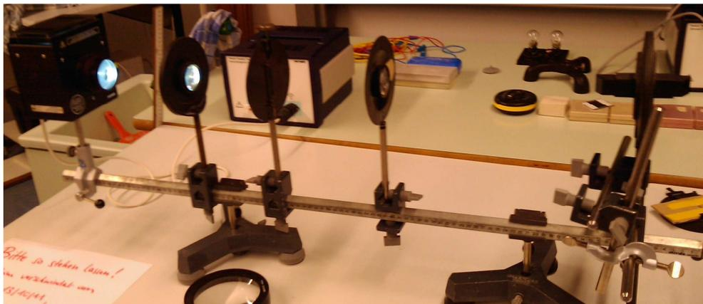
Dabei kommt aus einer Quecksilberdampf Lampe ein Lichtstrahl. Dieser wird in der ersten Linse auf einen schmalen Spalt fokussiert. Dieser wird wieder über eine Linse auf ein Prisma geführt und dieses Prisma spaltet die Farben des HG-Lichtes in saubere Linien auf (daher nimmt man gerade Quecksilberlampen...):
