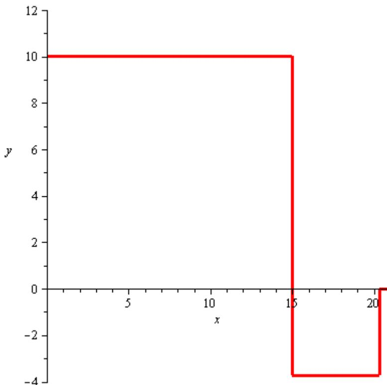
**Wobei hier die Achsenbeschriftungen fehlen!!! Die sind wichtig und zwar: x-Achse misst Zeit in Minuten und y-Achse misst die Zu/Abflussgeschwindigkeit in Litern pro Minute. Und ich ging hier davon aus, dass danach der Abfluss zu war und daher der Fluss bei 0 Litern pro Minute weitergeht.**
